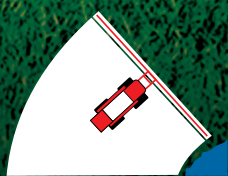
RAMPE AVEC COMPENSATION VIRAGE
