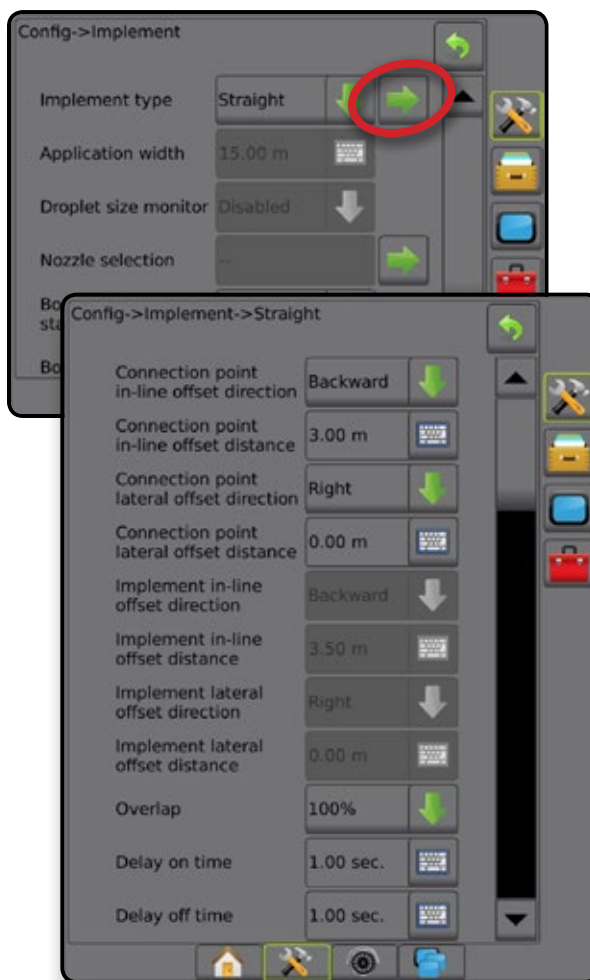
Figura 27: Tipo attrezzo rettilineo con irroratrice ISOBUS
