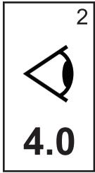
В режиме движения по прямой выполните точную настройку “прогнозирования” с использованием нескольких приближений к направляющей линии. Если транспортное средство выходит за пределы направляющей линии при приближении, увеличьте значение. Если транспортное средство не выходит за пределы направляющей линии, а вместо этого слишком долго достигает направляющей линии, уменьшите значение “прогнозирования” (Look Ahead).
