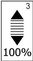
Перекрытие определяет размер перекрытия, которое допустимо при включении и выключении секций штанги. Выберите процент перекрытия от трех предварительно определенных настроек (0 %, 50 % и 100 %), используя клавиши «плюс»  $\oplus$  и «минус»  $\ominus$ . Нажмите клавишу “ВВОД”  $\rightarrow$  (ENTER) для принятия изменений и перехода к настройке “Количество секций штанги” (Number of Boom Sections).
