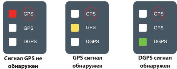
Если лампа DGPS мигает, была установлена связь с источником GPS; однако интенсивность сигнала NMEA на выходе слишком низкая. Обеспечьте правильные настройки NMEA-сообщения 5 GGA в устройстве GPS. Обработка не может осуществляться до тех пор, пока не будет установлена правильная связь.
