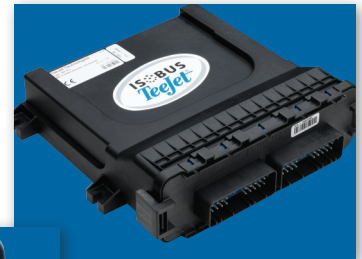
IC18 SPROEIER ECU EN IC18 STROOIER ECU GEBRUIKEN DEZELFDE BEHUUZING MAAR BIEDT ANDERE FUNCTIONALITEIT
