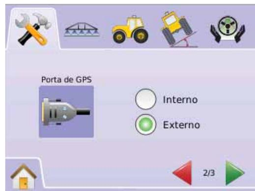
*NOTA: Trabalhando com sinais de GPS tais como Omnistar HP/ XP ou RTK, necessitará que a porta GPS seja ajustada para Externo.*
