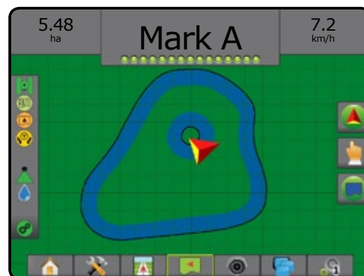
Figura 14: Aggiungere un confine interno
