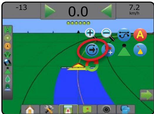
Pour voir quelle est la ligne de guidage active, appuyez sur l'icône mode de guidage de la barre d'état.
