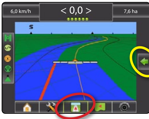
Figura 1-16: Ghidare vedere de pe parcelă
