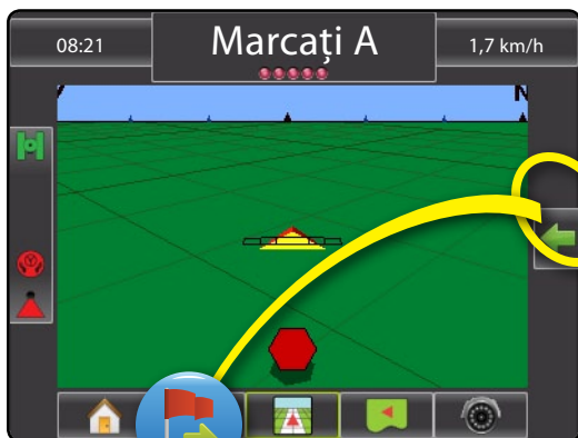
Figura 1-12: Punct de revenire stabilit - Vedere din vehicul
