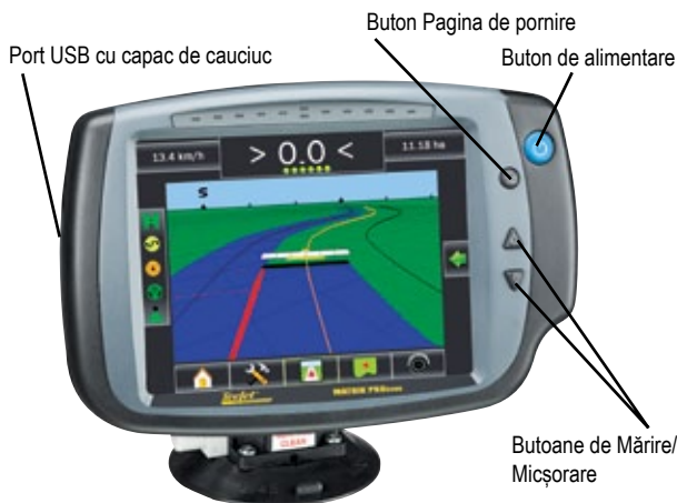
Figura 1-2: Ecran de pornire cu semnal GPS valid
