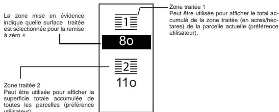
Pour remettre à zéro un compteur de surface, à partir de l'écran de surface traitée, appuyer sur la touche Entrée (Enter) pour mettre en évidence le compteur 1. Appuyer sur la touche Moins et la maintenir enfoncée pendant environ 3 secondes pour remettre à zéro le total de surface traitée 1. Si le compteur de surface a été remis à zéro par erreur, appuyer sur la touche Plus de nouveau pour rétablir la valeur.
