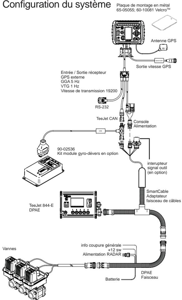
Éviter de fixer l'antenne à proximité d'autres installations électriques (climatisation, antennes radio, etc.). Eviter d'enrouler le câble d'antenne – Positionner le câble en forme de 8 et veiller à ce qu'il soit à 45 cm minimum des éventuelles sources d'interférences électriques.
