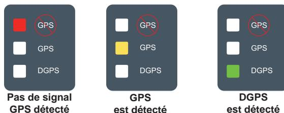
Si le voyant DGPS émet un flash, la communication a été établie avec la source GPS. Cependant, le débit de sortie NMEA est trop faible. Vérifier que les paramètres du message NMEA GGA est bien en 5 Hz dans le récepteur GPS. L'application ne peut se faire que lorsqu'une communication correcte est établie.
