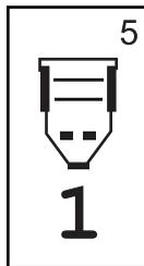
La porte série RS232 peut être paramétrée comme on le souhaite pour envoyer des données DGPS ou pour recevoir des données DGPS externes. «0» signifie que la console accepte des données DGPS externes. «1» signifie que la console utilise actuellement le récepteur DGPS interne et transmet des données vers l'extérieur. Utiliser les touches Plus et Moins pour modifier la porte série RS232. Appuyer sur la touche Entrée (Enter) pour valider les modifications.
