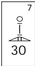
Déterminer la distance entre l'antenne GPS et la rampe en mètres avec décimales (pieds avec décimales). La distance rampe – antenne est de 0 à 50 mètres avec décimales (0 à 164 pieds avec décimales). Appuyer sur les touches Plus **+** ou Moins **-** pour modifier la valeur. Appuyer sur la touche Entrée **↵** (Enter) pour valider les modifications.
