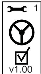
Activation de l'autoguidage permet d'activer ou de désactiver la fonction de l'autoguidage. Appuyer sur les touches Plus **+** ou Moins **-** pour commuter entre « Marche » et « Arrêt ». Appuyer sur la touche Entrée **↵** (Enter) pour valider les modifications et passer au paramétrage Anticipation de trajectoire.
