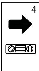
Tourner le véhicule à 180 degrés et repositionner le véhicule au même emplacement. Appuyer sur la touche Entrée **↵** (Enter) pour enregistrer la position du niveau.
