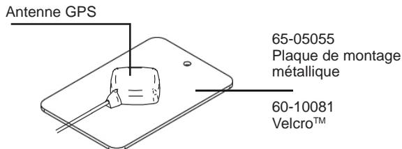
Positionner l'antenne GPS au milieu du véhicule sur le point le plus haut avec une vue dégagée vers le ciel. Si la cabine du tracteur n'est pas métallique, fixer la plaque de montage (65-05055) au milieu du véhicule sur le point le plus haut à l'aide de bandes Velcro™ et placer l'antenne sur la plaque. Faire passer le câble d'antenne avec précaution pour ne pas l'abîmer et pour éviter les éventuelles interférences électriques.
