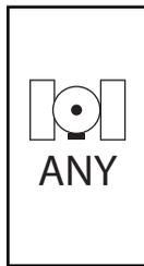
Le Configuration du GPS permet de régler comme on le souhaite pour accepter «TOUTS» (ALL) les signaux (non corrigés ou différentiels), les signaux «GPS» (uniquement les signaux non corrigés) ou les signaux «DGPS» (uniquement les signaux à différentiel corrigé). Appuyer sur la touche Plus pour sélectionner «TOUTE» (ALL), «GPS» ou «DGPS» et sur la touche Moins pour revenir en arrière. Appuyer sur la touche Entrée (Enter) pour valider les modifications.
