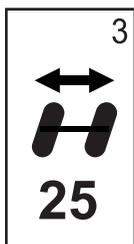
Typiquement, régler cette valeur pendant le mode GUIDAGE COURBE. Si le véhicule coupe les angles, réduire cette valeur par pas de 1. Si le véhicule passe en dehors des angles, augmenter cette valeur. Appuyer sur les touches Plus **+** ou Moins **-** pour augmenter ou diminuer la valeur de 1 à 100 (par défaut : 25). Appuyer sur la touche Entrée **↵** (Enter) pour valider les modifications et passer au paramétrage Gain de vanne.
