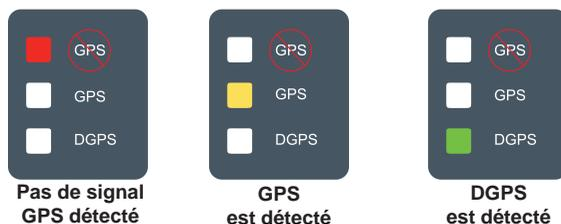
Si le voyant DGPS clignote, la communication a été établie avec la source GPS. Cependant, le débit de sortie NMEA est trop faible. Vérifier l'exactitude des paramètres du message NMEA GGA à 5 Hz dans le récepteur GPS. L'application ne peut se faire que lorsqu'une communication correcte est établie.
