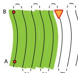
**REMARQUE :** Il est recommandé que le guidage en courbe ne dépasse pas 30° par rapport à la ligne guide A-B.
