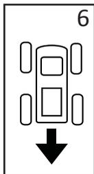
La sélection DERRIÈRE (comme le montre le schéma) indique que la rampe est située derrière l'antenne GPS lorsque le véhicule avance. Une sélection DEVANT indique que la rampe est située devant l'antenne GPS lorsque le véhicule avance. Appuyer sur les touches Plus **+** et Moins **-** pour choisir Devant ou Derrière. Appuyer sur la touche Entrée **↵** (Enter) pour valider les modifications et passer au paramétrage Distance rampe – antenne.
