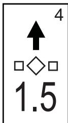
La distance représentée par les Diodes allumées peut être réglée. Par défaut, cette distance est de 30 cm (1,5 pieds). Appuyer sur les touches Plus et Moins pour régler l'espacement souhaité. Appuyer sur la touche Entrée (Enter) pour valider les modifications.
