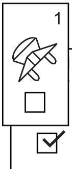
Le module de gyro-devers permet de corriger l'inclinaison. Une page Activation/Désactivation de la correction de dévers s'affiche. Si la page affiche une case non cochée, les écrans de calibrage de dévers ne sont pas disponibles. Si la case est cochée, les écrans de calibrage de dévers sont disponibles. Si la case est cochée et qu'un calibrage a déjà été effectué, appuyer sur la touche Echappe (Escape) pour éviter d'effectuer une nouvelle procédure de calibrage.
