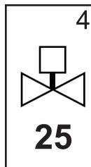
Si le véhicule dévie de la ligne ou ne s'en approche pas assez vite, augmenter le paramétrage Gain de vanne par pas de 1. Diminuer la valeur si le véhicule oscille rapidement ou dépasse la ligne guide. Appuyer sur les touches Plus **+** ou Moins **-** pour augmenter ou diminuer la valeur de 1 à 100 (par défaut : 25). Appuyer sur la touche Entrée **↵** (Enter) pour valider les modifications et passer au paramétrage Sensibilité.
