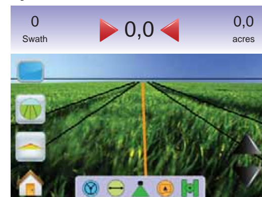
Figuur 3-53: VSM Niet Geïnstalleerd
