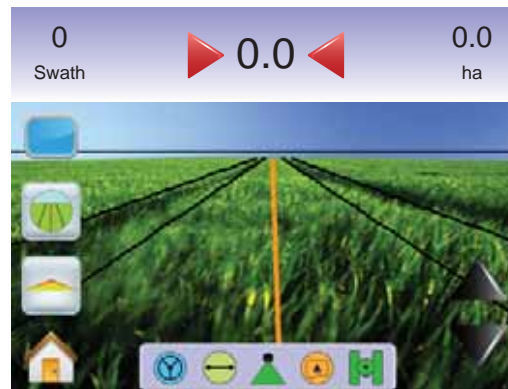
Kuva 3-53: VSM ei ole asennettu
