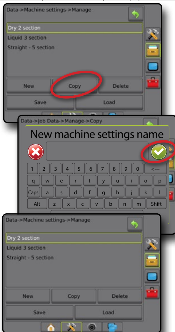
Рисунок 34 — Настройки машины — копирование профиля
