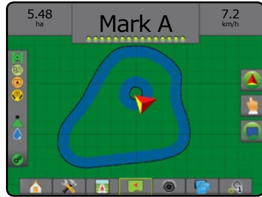
Figura 14: Adicionar limite interno
