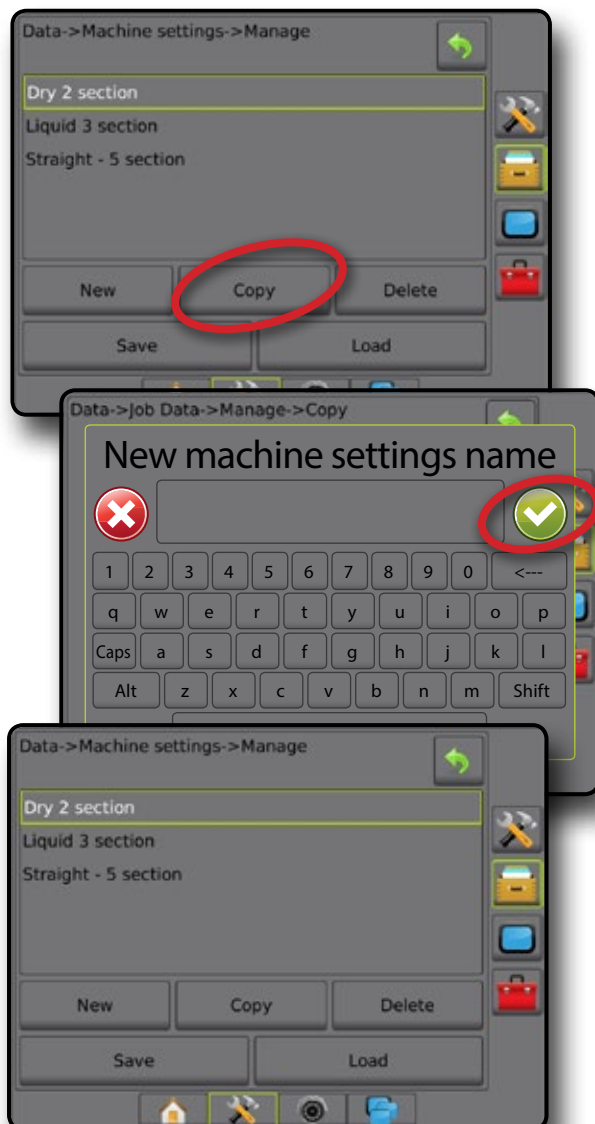
Figura 34: Configuración de la máquina: copiar perfil
