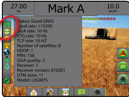
Figura 5-6: Informações do status de GNSS na tela de orientação
