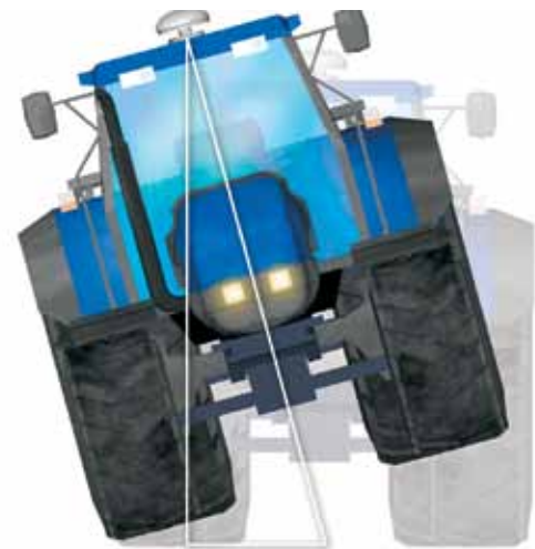
COMPENSAÇÃO DE INCLINAÇÃO E ESTABILIZADOR DE CURVA CORRIGEM OS ERROS DE DECLIVES E ASSEGURAM PRECISÃO
