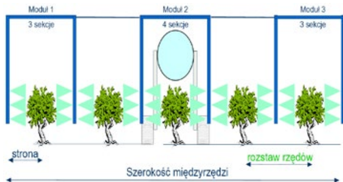
Rysunek 5: Zasada działania opryskiwacza wielorzędowego (HC)
