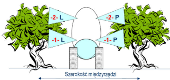
Rysunek 4: Zasada działania opryskiwacza z pomocniczym strumieniem powietrza (AB)
