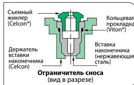
**Примечание:** поскольку этот наконечник имеет конструкцию с жиклером, его нельзя использовать с фильтром наконечника обратного клапана 4193А.
