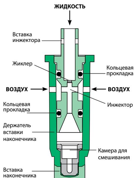
**Примечание:** поскольку этот наконечник имеет конструкцию с жиклером, его нельзя использовать с обратным клапаном 4193A.
