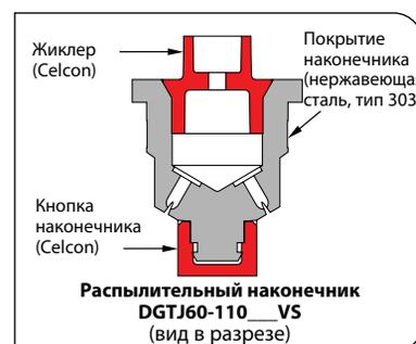
**Примечание:** поскольку этот наконечник имеет конструкцию с жиклером, его нельзя использовать с фильтром наконечника обратного клапана 4193A.
