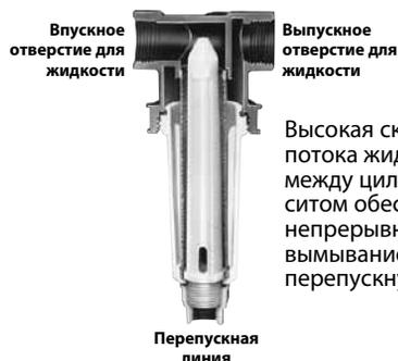
Высокая скорость потока жидкости между цилиндром и ситом обеспечивает непрерывное вымывание частиц в перепускную линию.
