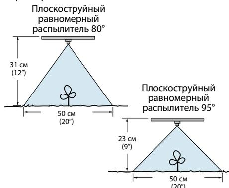
Угол распыления насадки и ширина полосы распыления прямо зависят от давления распыления.
