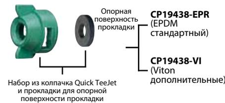
Колпачки Quick TeeJet изготавливаются с выемками для размещения в ограничительных выступах на корпусе насадки. Колпачки изготавливаются из нейлона и их можно использовать со всеми распылительными наконечниками TeeJet®. Максимальное рабочее давление 20 бар (300 PSI).
