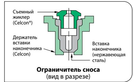
**Примечание:** поскольку этот наконечник имеет конструкцию с жиклером, его нельзя использовать с фильтром наконечника обратного клапана 4193А.
