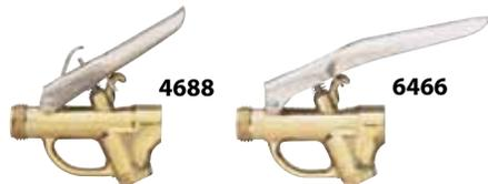
**Триггерный клапан 4688** с блокировкой триггера Макс. расход—7,6 л/мин (2 GPM), макс. давление—17 бар (250 PSI). Впускное соединение со внутренней резьбой NPT 1/4", выпускное соединение 16 с наружной резьбой 1/16". Используется с наконечниками TeeJet и ConeJet®, регулируемые наконечниками ConeJet и наконечниками MulteeJet®. Изготовлен из латуни.
