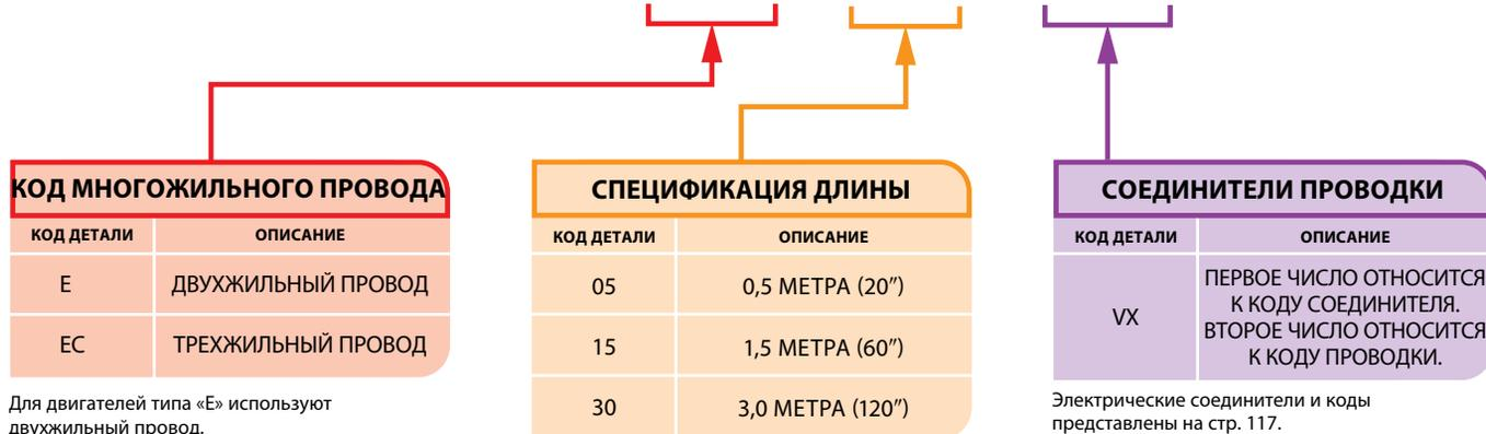
Для двигателей типа «E» используют двухжильный провод.
