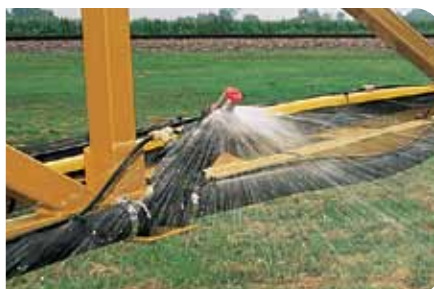
Rozpylacz można zamontować pod kątem od 0° do 45°
