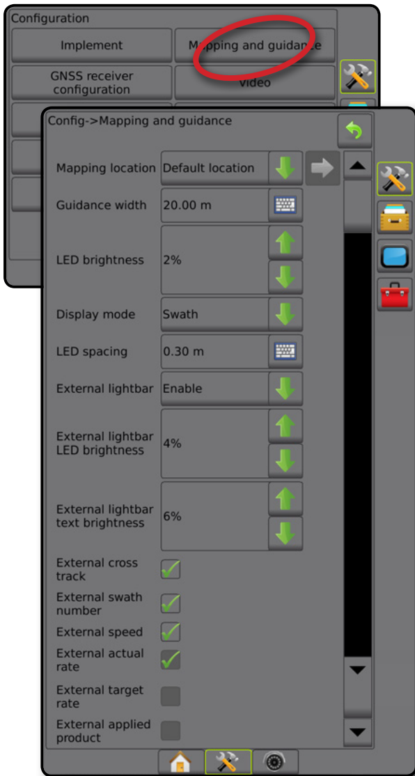
Rysunek 4-13: Mapowanie i nawigacja z zewnętrznym paskiem LED
