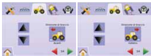
Figura 2-50: Posizione della Barra
