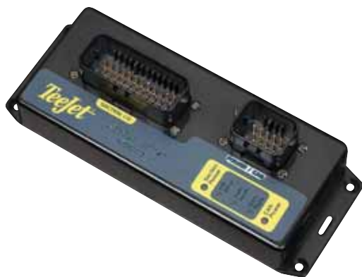
Figura 1-10: Modulo di attivazione delle sezioni di barra
