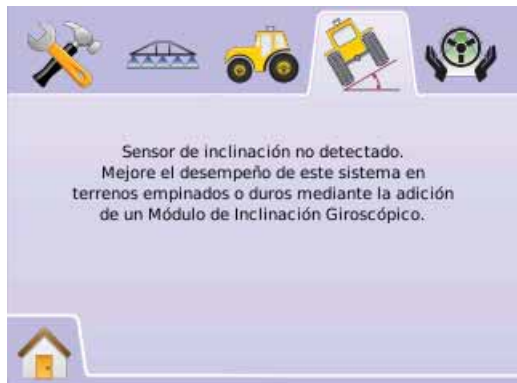
Figura 2-53: Módulo Corrector de Inclinación No Detectado
