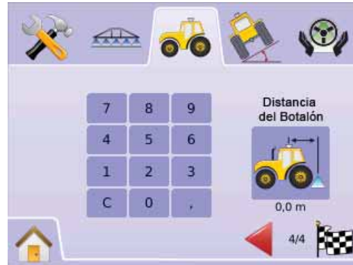
Figura 2-51: Compensación por Distancia del Botalón
