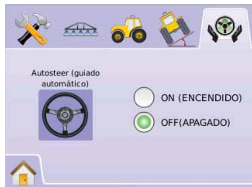
Figura 2-61: Auto guiado Encendido/Apagado
