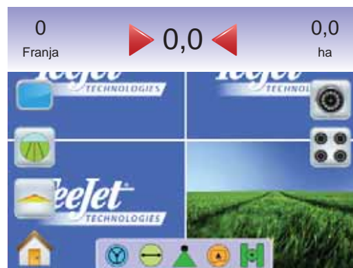
Figura 3-58: Puertos de Cámaras Inactivos
