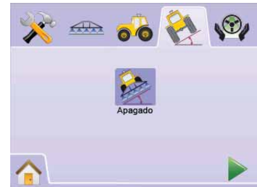
Figura 2-52: Corrección de Inclinación
