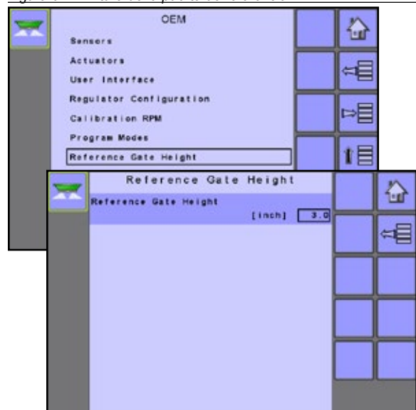
Figura 6-14: Altura de la puerta de referencia
