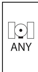
La Configuración GPS puede personalizarse para aceptar “CUALQUIER” (“ANY”) transmisión fuente disponible (ya sea no corregida o diferencial), transmisiones fuente “GPS” (únicamente señales no corregidas), o transmisiones fuente “DGPS” (únicamente señales corregidas diferencialmente). Utilice la tecla Más **+** para seleccionar “ANY”, “GPS”, o “DGPS” y la tecla Menos **-** para retroceder. Presione la tecla Enter [entrar] **↵** para aceptar los cambios.
