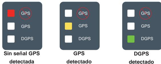
Si la luz DGPS está destellando, se ha establecido la comunicación con la fuente GPS; sin embargo, la velocidad de salida NMEA es demasiado lenta. Asegure los ajustes apropiados del mensaje NMEA de 5 Hz GGA en el dispositivo GPS. La aplicación no funcionará hasta que se establezca la comunicación apropiada.
