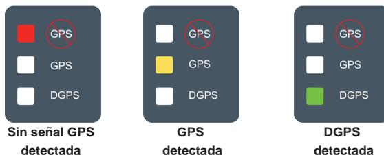
Si la luz DGPS está destellando, se ha establecido la comunicación con la fuente GPS; sin embargo, la velocidad de salida NMEA es demasiado lenta. Asegure los ajustes apropiados del mensaje NMEA de 5 GGA en el dispositivo GPS. La aplicación no funcionará hasta que se establezca la comunicación apropiada.
