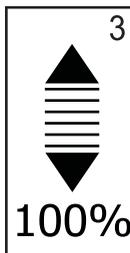
Superposición determina la cantidad de superposición permitida cuando las secciones de la barra se encienden o cierran. Seleccione el porcentaje de superposición a partir de tres configuraciones predeterminadas (0%, 50%, y 100%) utilizando las teclas Más  $\oplus$  y Menos  $\ominus$ . Presione la tecla Enter [entrar]  $\rightarrow$  para aceptar los cambios y avanzar hacia el ajuste de Número de Secciones de la barra.
