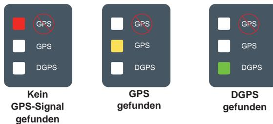
Wenn die LED „DGPS“ blinkt, wurde die Verbindung mit der GPS-Quelle hergestellt, aber die NMEA-Ausgaberate ist zu langsam! Sorgen Sie dafür, dass die NMEA-Einstellungen in Ihrem GPS stimmen: 5 Hz GGA. Das Gerät kann nicht verwendet werden, solange die Verbindung nicht korrekt hergestellt wird!
