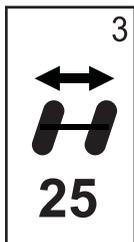
Dieser Wert wird am besten im Modus KURVE A-B eingestellt. Schneidet das Fahrzeug die Kurven, muss der Wert vermindert werden. Gerät das Fahrzeug aus der Kurve, erhöhen Sie den Wert. Mit den Plus- und Minus- Tasten kann der Wert im Bereich zwischen 1 und 100 verstellt werden (werkseitige Einstellung ist 25). Mit „Enter“ wird die Einstellung gespeichert. Es geht weiter mit „Ventilsteuerung“.
