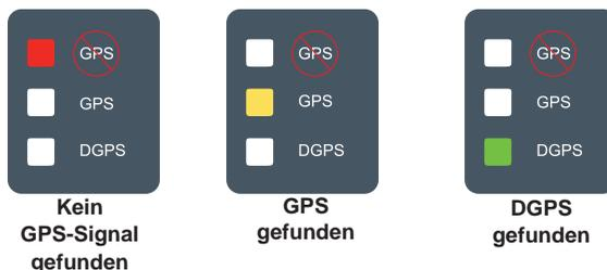
Wenn die LED „DGPS“ blinkt, wurde die Verbindung mit der GPS-Quelle hergestellt, aber die NMEA-Ausgaberate ist zu langsam! Sorgen Sie dafür, dass die NMEA-Einstellungen in Ihrem GPS stimmen: 5 GGA. Das Gerät kann nicht verwendet werden, solange die Verbindung nicht korrekt hergestellt wird!
