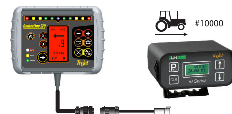
Adapterkabel, hastighet: Art. nr.: 6070-45-20042 Kalibreringstal, hastighet för 70 seriens monitorer: 10000
