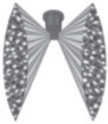
図9 前方向で穂先を揺らし、後ろ方向で全体的に薬を噴霧する
