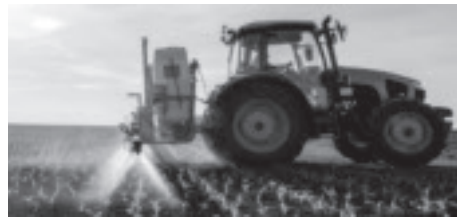
写真2 前後2方向に散布するツインタイプ
