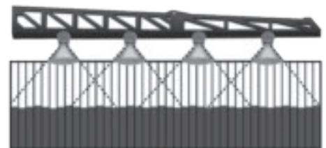
図4 均一な散布を目指すなら、フラットス プレー以外の選択肢はない
