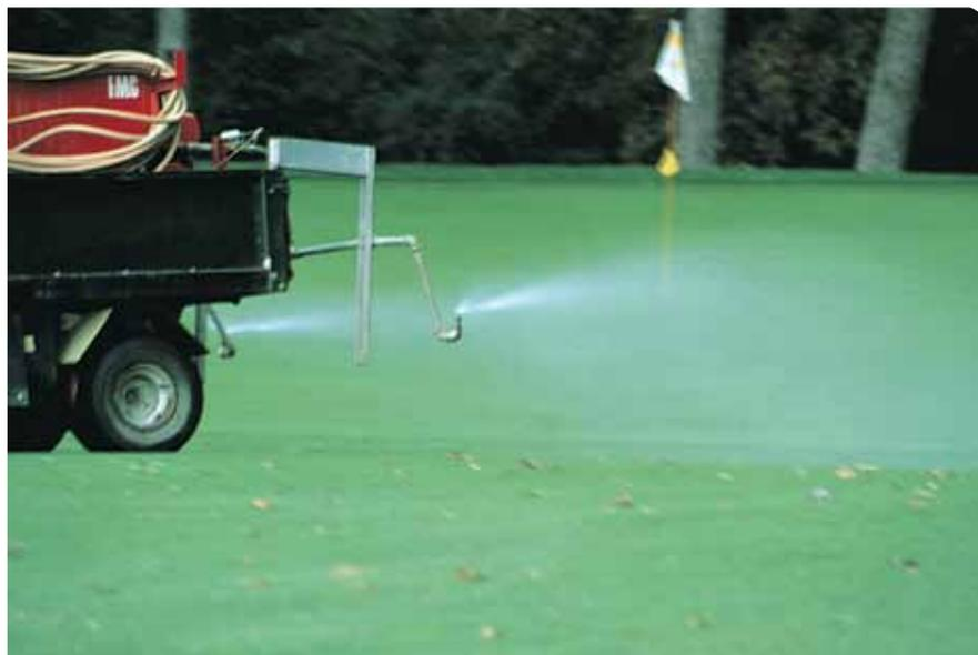
L'ugello FieldJet KLC viene tipicamente usato per trattare le aree non accessibili con barre irroratrici. Il design dell'ugello a pezzo unico proietta il liquido erogato verso entrambi i lati, formando un ampio getto piatto. L'orifizio tondo riduce gli intasamenti. L'uniformità della passata non è pari a quella fornita da una barra irroratrice. \*Disponibile in ottone o in acciaio inox.
