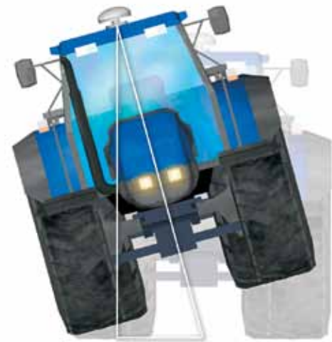
EL CORRECTOR POR COMPENSACION DE INCLINACION Y ESTABILIZACION DE GIROS DISMINUYE ERRORES EN PENDIENTES Y GARANTIZA PRECISIÓN
