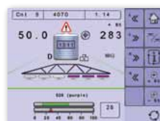
CONTROL AUTOMÁTICO DE SECCIONES DE LA BARRA
