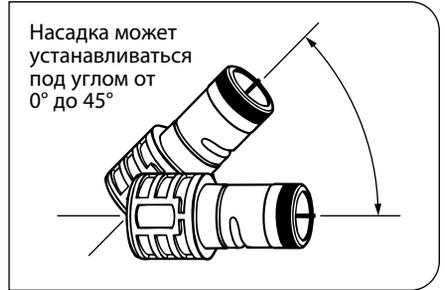
Революционная насадка Quick Turbo FloodJet сочетает точность и равномерность плоскоструйной распылительной насадки с устойчивостью к засорению и широкоугольным рисунком распыления оросительных насадок. Новая конструкция для увеличения размера капель и равномерного распределения.
