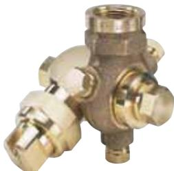
Насадка типа 4629-3/4-ТОС с одним шарниром и трубным соединением с внутренней резьбой NPT 3/4". Латунь.
