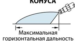
При передвижении триггера назад, сначала клапан перейдет из положения перекрытия в положение распыления с большим углом конуса, затем угол конуса будет постепенно уменьшаться
