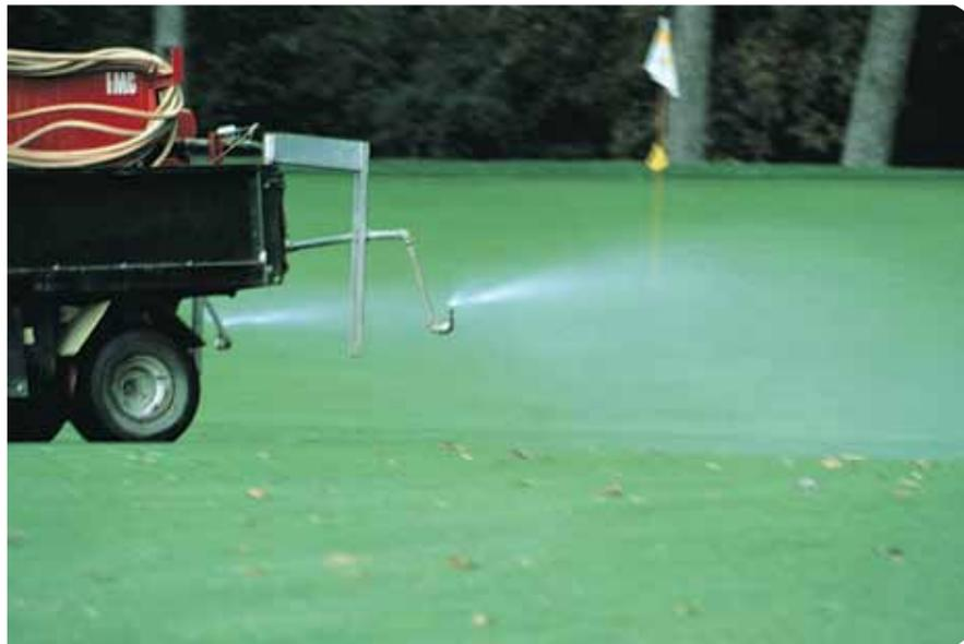
Насадка KLC FieldJet обычно используется для распыления на участках, недоступных для распыления со штангой. Конструкция этой одноструйной насадки обеспечивает распыление в обе стороны для формирования широкой полосы распыления. Большое круглое отверстие снижает вероятность засорения. Равномерность по полосе распыления не такая хорошая, как при правильном использовании распылителя со штангой.\* Изготавливается из латуни и нержавеющей стали.
