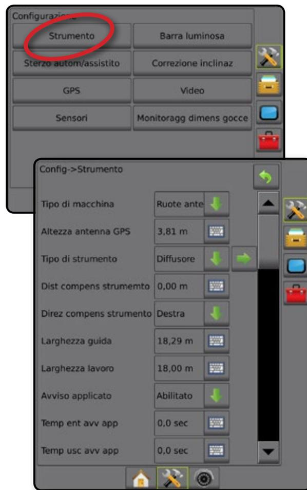
Figura 8-9: Direzione e distanza di compensamento strumento
