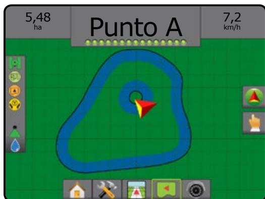
Quando si crea un contorno esterno o iniziale, la linea del contorno si collocherà all'esterno della sezione della barra più esterna. Quando si crea un contorno interno o aggiuntivo, la linea del contorno si collocherà all'interno della sezione della barra più interna.
