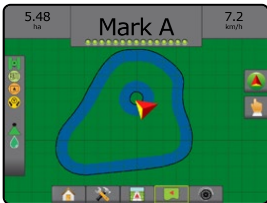
7-25 ábra: Belső határvonal hozzáadása
