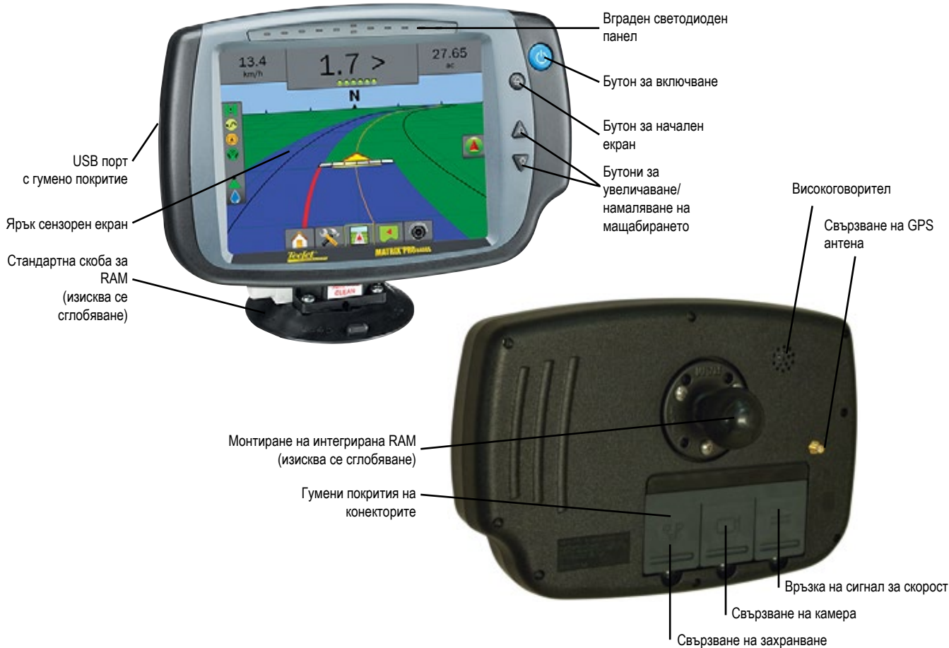
Фигура 1-2: Изглед отпред и отзад на конзола Matrix Pro 840GS
