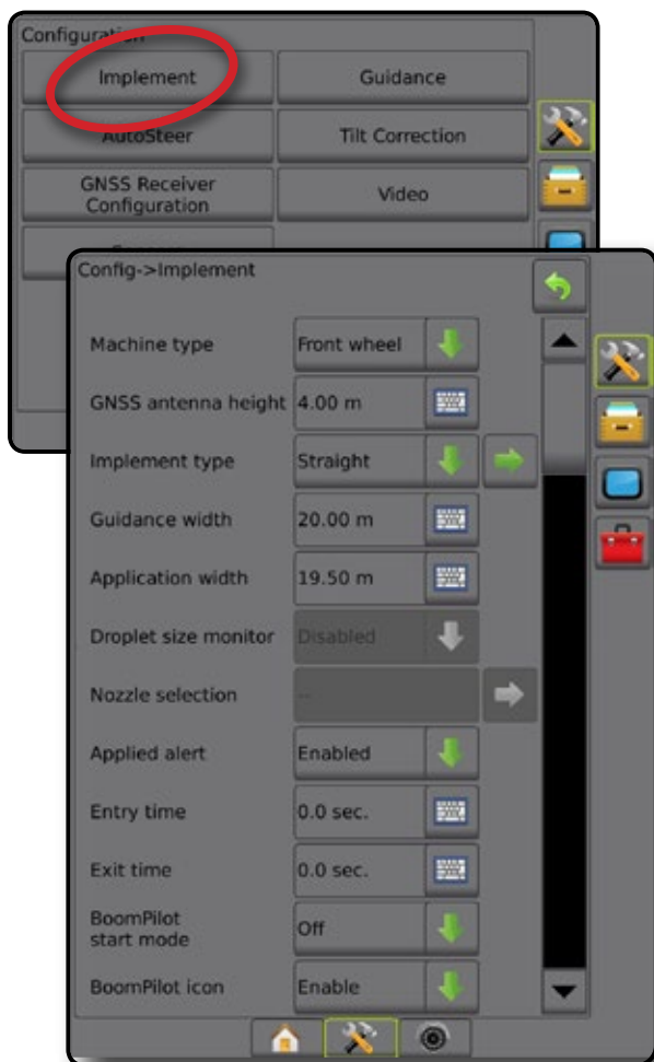
Фигура 4-6: Прикачно устройство–Настройка на единична секция
