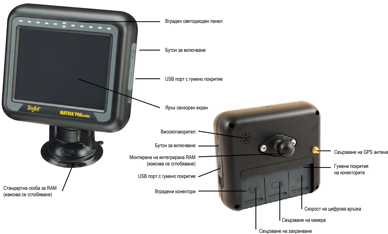
Фигура 1-1: Изглед отпред и отзад на конзолата Matrix Pro 570GS
