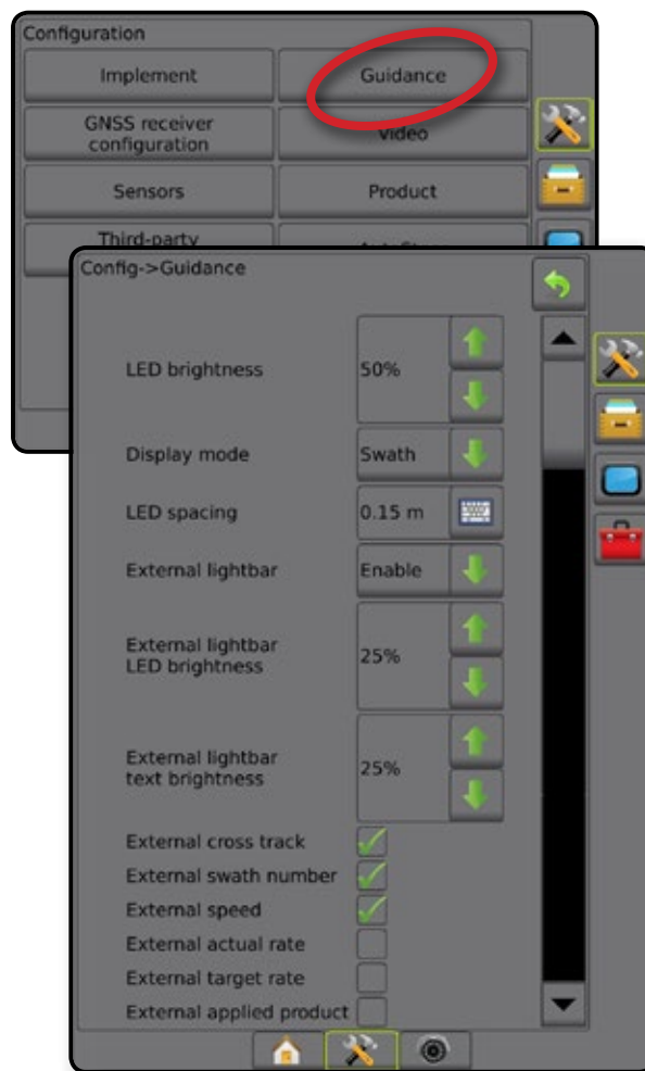
Фигура 4-11: Навигация с модул за външен светодиоден панел (ELM)
