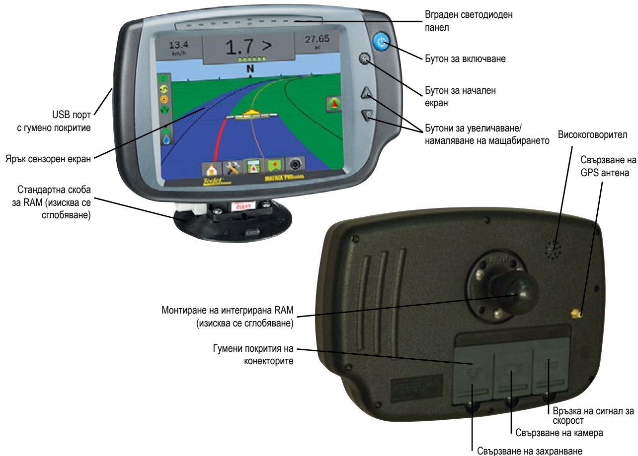
Фигура 1-2: Изглед отпред и отзад на конзола Matrix Pro 840GS
