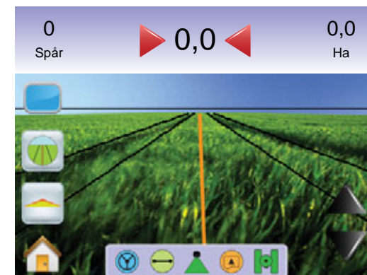
Figur 3-58: VSM Ej Installerad
