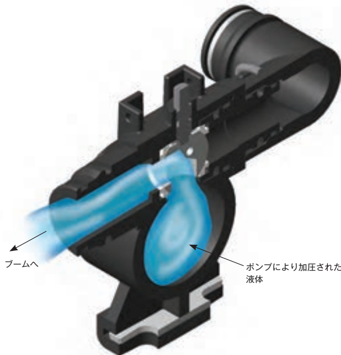
フローバックバルブ開時
