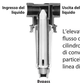
L'elevata velocità del flusso di liquido tra cilindro e rete permette di convogliare le particelle verso la linea di bypass.
