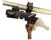
**Elektronische Düsensteuerung mit Pulsweitenmodulation „DynaJet“ mit den TeeJet-Düsen AITTJ60 110 06 und AIC 110 05 VP**
